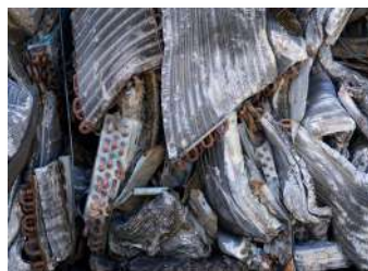
CU / AL RADIATORS
