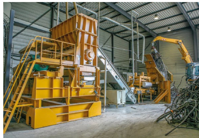
MTB fabrique également des broyeurs et des granulateurs pour les câbles en cuivre et en aluminium.
